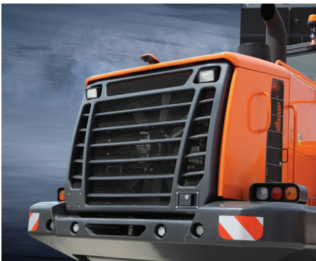
Grade do radiador (Estrutura em aço)
