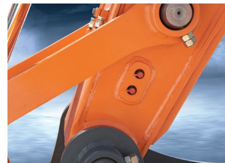
Entradas de lubrificação centralizadas para fácil manutenção
