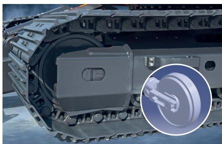
Mola e roda-guia da esteira integradas A mola da esteira e a roda-guia foram diretamente unidas para obter alta durabilidade e maior conveniência de manutenção.
